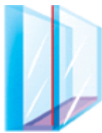
Vitrage Phonique 10-10-4 Faible émissivité avec gaz Argon (Phonique)
